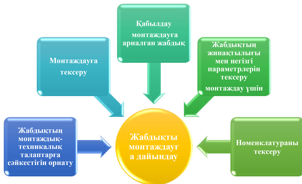
2.2-Сызба-технологиялық жабдықты монтаждауға дайындау
