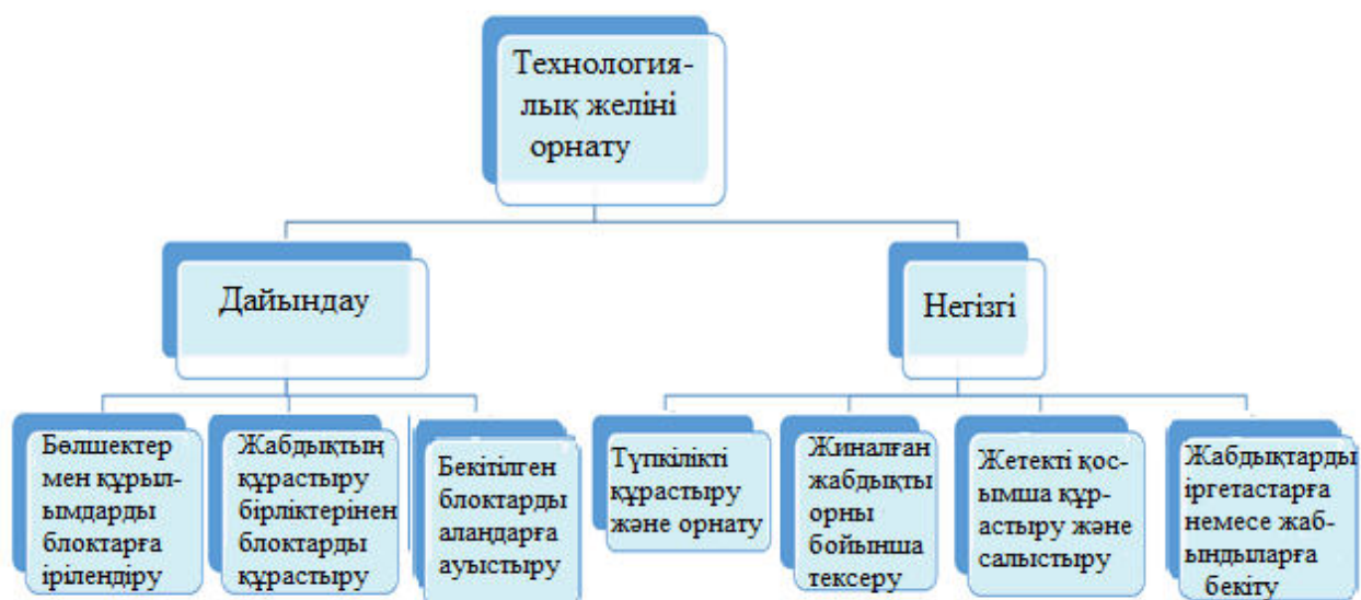
2.3-Сызба-Технологиялық желілерді монтаждау түрлері
