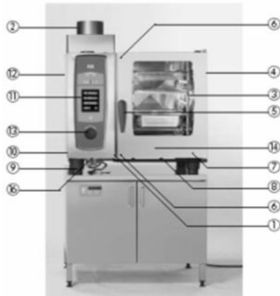
2.10.2-сурет. Буконвектоматтың технологиялық сызбасы
