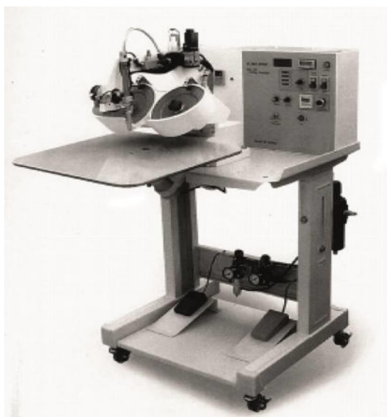
131 сур. Киімнің фурнитурасын бекітуге арналған ультразвальный қондырғы
