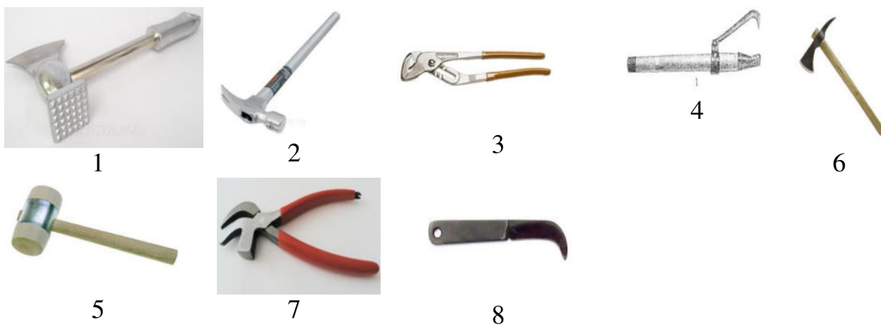
26-сурет - 1 – кіші балта-балға; 2 - балға-шеге суырғыш; 3 - қысқыштар; 4 – бөшке құрсауларын алғыш; 5–ағаш балға; 6- томагавк; 7 – шеге суырғыш-қайшы; 8–қаптарды ашуға арналған пышақ.
