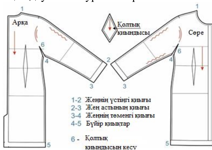
Сурет 1.114 - Пішу бөлшектері, кесіктердің атауы және тұтас пішілген жеңдері бар пальто бөлшектерін ылғалды-жылумен өңдеу
