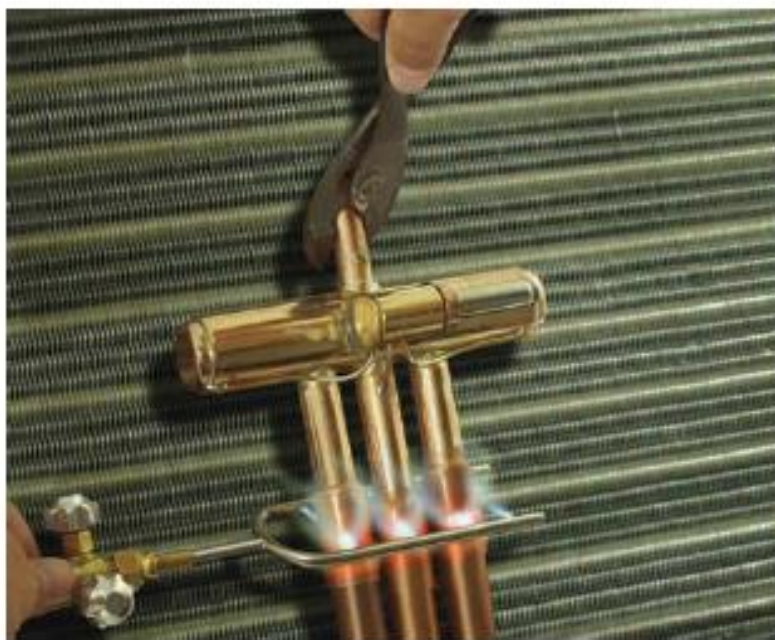
3.45- сурет. Төрт жақты клапанды дәнекерлеуге арналған саптама
