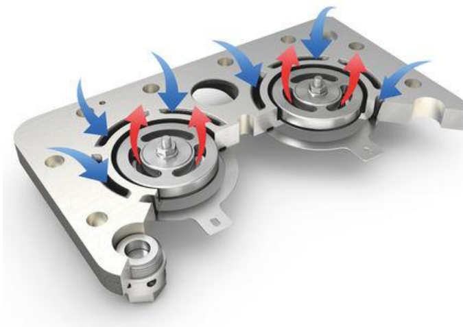
2.8- сурет.Клапан тақтасында сақина клапандар
